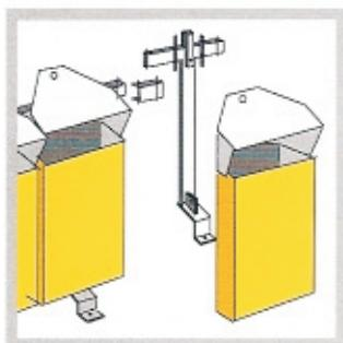
Semplicità di montaggio del contenitore singolo mediante staffa da fissare a parete.
