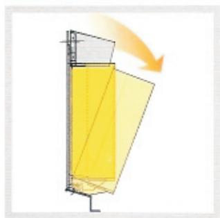
Inclinando il contenitore si può estrarre il medesimo per pulizia o svuotamento e sostituire il sacchetto.
