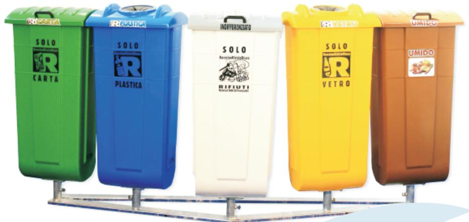
I contenitori POLYBOX sono realizzati in polietilene lineare con il coperchio in ABS verniciato. I componenti metallici sono in acciaio inox e ottone. Ciò garantisce grande durata e resistenza alle intemperie. L'installazione di POLYBOX è semplice e pratica grazie al paletto di sostegno fissato nel terreno. Tale supporto metallico è zincato a caldo. POLYBOX può essere composto con installazione in linea o ad isola a tre o quattro elementi.
